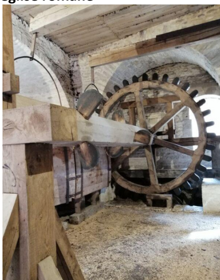
25 Roue à aubes des Grandes Forges de Buffon
